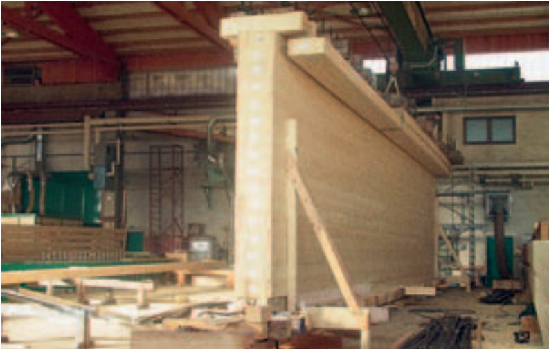
Das hochkant stehende Brückenelement nach der Blockverleimung im Werk
